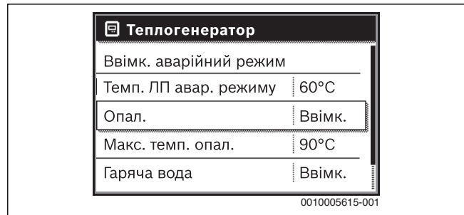
Мал. 5 Ввімкнення системи опалення
