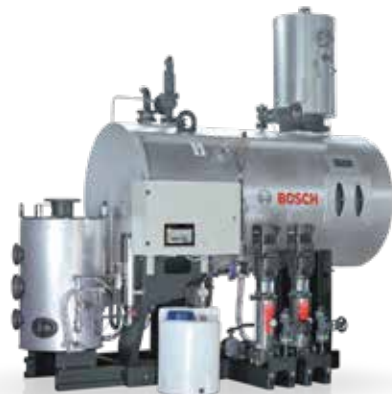
Модуль повної термічної деаерації WSM для всіх парових котлів з продуктивністю від 2 000 до 100 000 кг/год.
